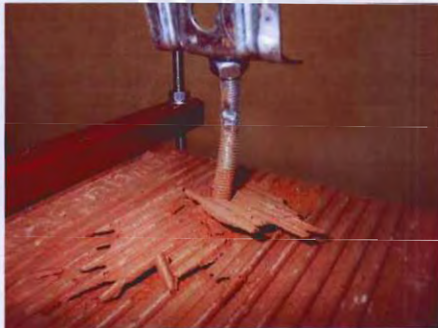
Modalidad de rotura de la barra roscada y del ladrillo perforado.
